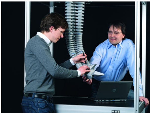
Abb. 3 Der bionische Handling-Assistent von Festo als ein Beispiel bionischer und inhärent sicherer Automatisierung, Quelle: Festo AG & Co. KG
