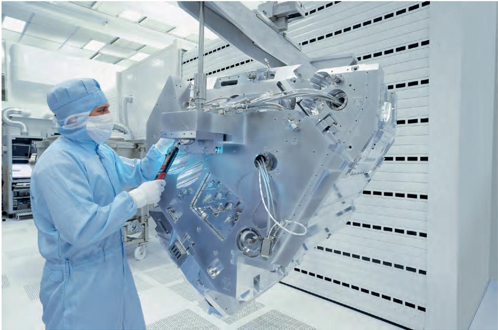
Abb. 3: Teil der EUV-Lithographie-Optik in der Fertigung von Zeiss
